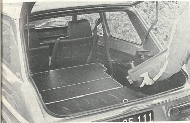
Bagsæde-arrangementet er uhyre praktisk. Hylden ved bagdøren fjernes let, så man har en hel »stationcar«.
