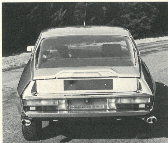
Citroën SM har elektrisk opvarmet bagrude, store baklygter og store baglygter samt tydelige blink- og stoplys. Bemærk de brede dæk og det dobbelte udblæsningssystem, der dog har fælles rør fra motoren til de to lydæmpere.
