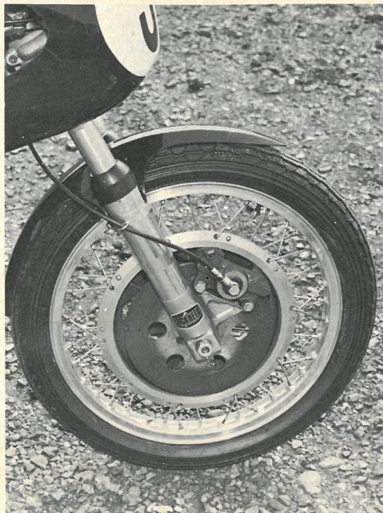
På Lockheed-Rickman's første skivebremser lå selve skiven endnu omtrent inde i hjulet. Skruen øverst på bremseåget er til udluftning af hydraulikken.
