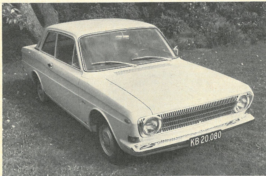
Taunus 12 M har fået nyt karosseri, ny forhjulsophængning, nyt styretøj, nyt kølesystem og undervognens plader har fået en elektrolytisk, rustbeskyttende behandling, medens man samtidig er gået over til at benytte akryllak.
