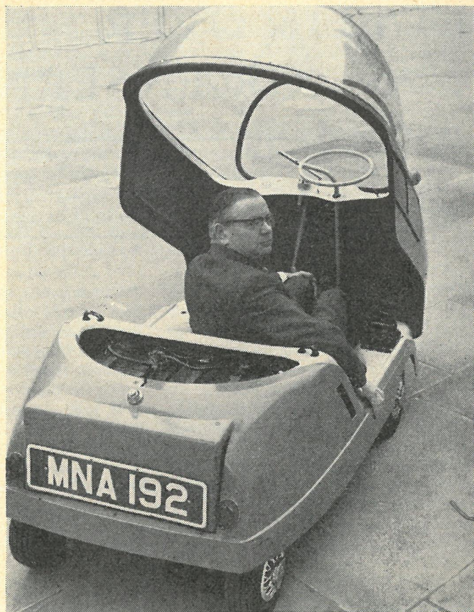
Bubble Car er en af de eksisterende bybiler, og den er her blevet elektrificeret af Peel Engineering, Isle of Man.
