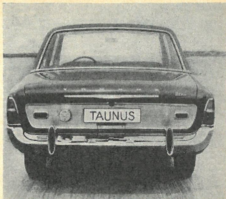
Det ses her tydeligt at bagagerumsklappen er hævet og nu ligger højere end skærmene.
