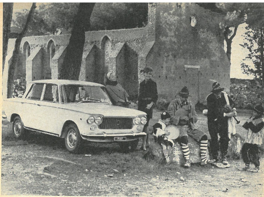
De fire forlygter indebærer bl. a. den fordel, at dynamoen skal have stor effekt.
