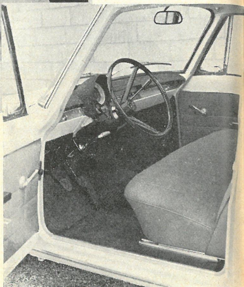
Instrumenter og kontrolgreb er hensigtsmæssigt anbragt, og det sorte forpanel forhindrer reflekser i vindspejlet.
