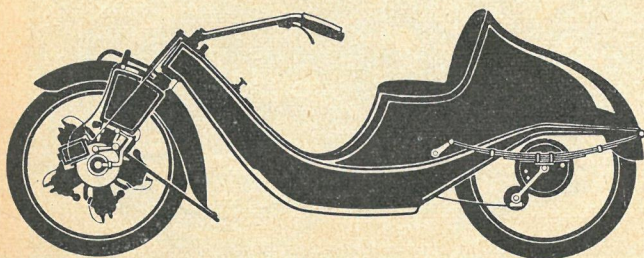
Den tyske Megola med fem-cylindret stjernemotor i forhjulet og baghjulet ophængt i halvelliptiske blad-fjedre må siges at være en absolut ener indenfor motorcykleindustrien.
