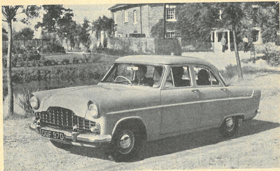
Ford Zephyr Mark II er med sine små hjul og uafhængig forhjulsaffjedring bedre egnet til landeveje af type 1906 end den gamle Renault. Ford'en har omtrent den samme effekt fra godt 2,5 liter slagvolumen. På en lige landevej vil den knap nok kunne klare sig overfor den 50 år ældre Renault, men den bruger også kun halvt så meget benzin.
