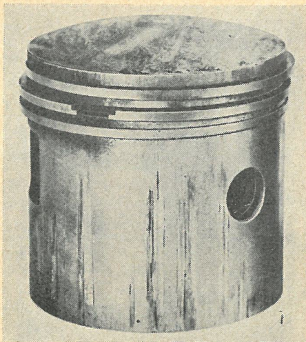
Stemplet fra denne to-takt motor er på tryksiden revet på grund af utilstrækkelig smøring, medens den modsatte side ikke bærer mærker efter riving. Stempelskørtet er uden højglanspoleret slidflade.
