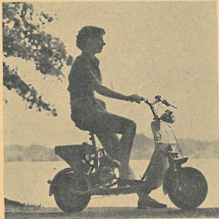
En lille mærkværdighed er den her viste »Ferbodo« knallert-scooter, model R 48, monteret med 48 ccm Zündapp motor. Benzinforsbruget er ca. 1,5 liter pr. 100 km, og tophastigheden er 40 km/t, marchhastigheden ansættes til ca. 25 km/t. Hele maskinen vejer 30 kg. (Pris i Tyskland 530 DM).
