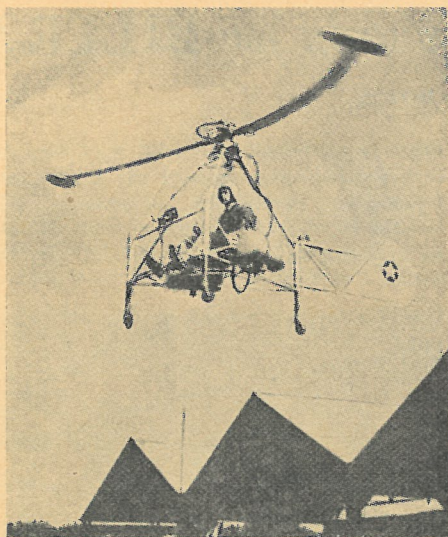
En af det amerikanske luftvåben udviklet 1-mands helikopter uden strømlinebeklædning — også den drives af to ramjet-aggregater, et i hver af rotorens vingespids. Både om denne og om Hiller helikopteren gælder det, at de arbejder med et meget højt specifikt brændselsforbrug, hvilket bl. a. begrænser deres aktionsradius. Se iverigt teksten.
