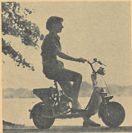
En lille mærkværdighed er den her viste »Ferbodo« knallert-scooler, model R 48, monteret med 48 ccm Zündapp motor. Benzinforbruget er ca. 1,5 liter pr. 100 km, og tophastigheden er 40 km/t, marchhastigheden ansættes til ca. 25 km/t. Hele maskinen vejer 30 kg. (Pris i Tyskland 530 DM).
