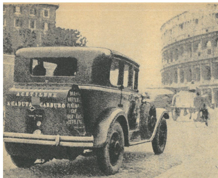
Ogsaa i Italien eksperimenterer man med at erstatte Benzin med Acetylengas.
