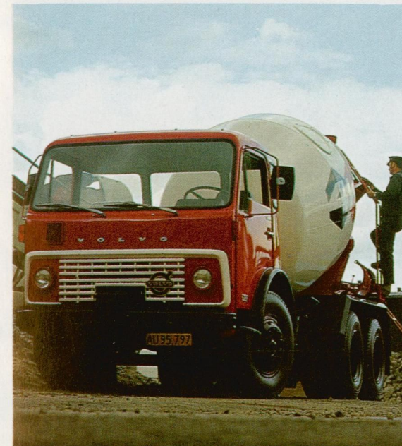
FB 86-34 med roterende betonmixer. TD 70. Frontmonteret hydraulpumpe. Enkeltreduktions-bagtøj.
