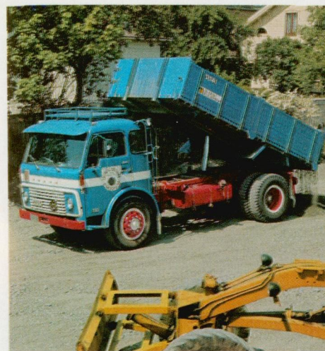
F86-38 med 3-vejs tip. TD 70. Enkeltreduktions-bagtøj. Bagste kraftudtag.
