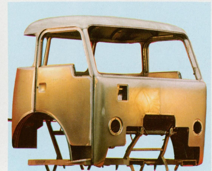
Volvo-førerhuset er hel-svejset over et stærkt skelet bestående af stålprofiler. Frontruden er af lamelglas og dørlåsene af sikkerhedstypen.
