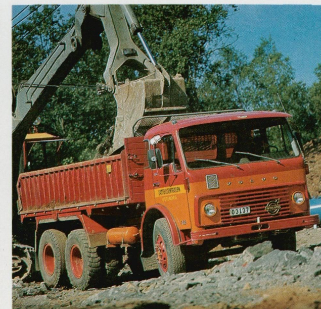
FB 86-34 bagtip med tippelad. TD 70. Dobbeltreduktions-bagtøj.
