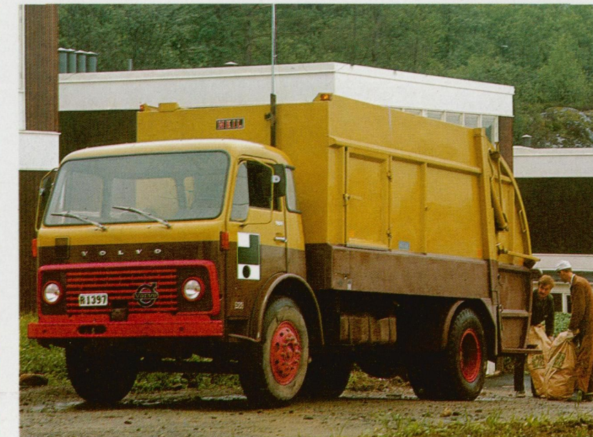
F86-42 renovationsvogn. D 70. Frontmonteret hydraulpumpe. Enkeltreduktions-bagtøj.
