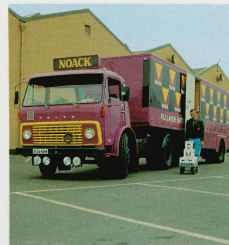
F86-34 med kassesættevogn. TD 70. Enkeltreduktions-bagtøj.
