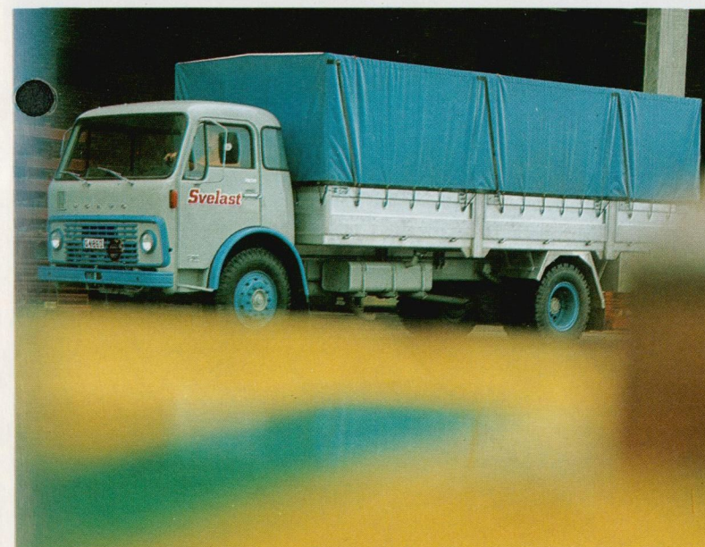
F86-49 med fast lad og presenning. TD 70. Enkeltreduktions-bagtøj.
