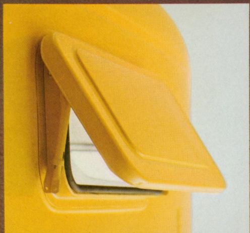
For yderligere at sikre en effektiv ventilation er førerhuset forsynet med lem i taget.
