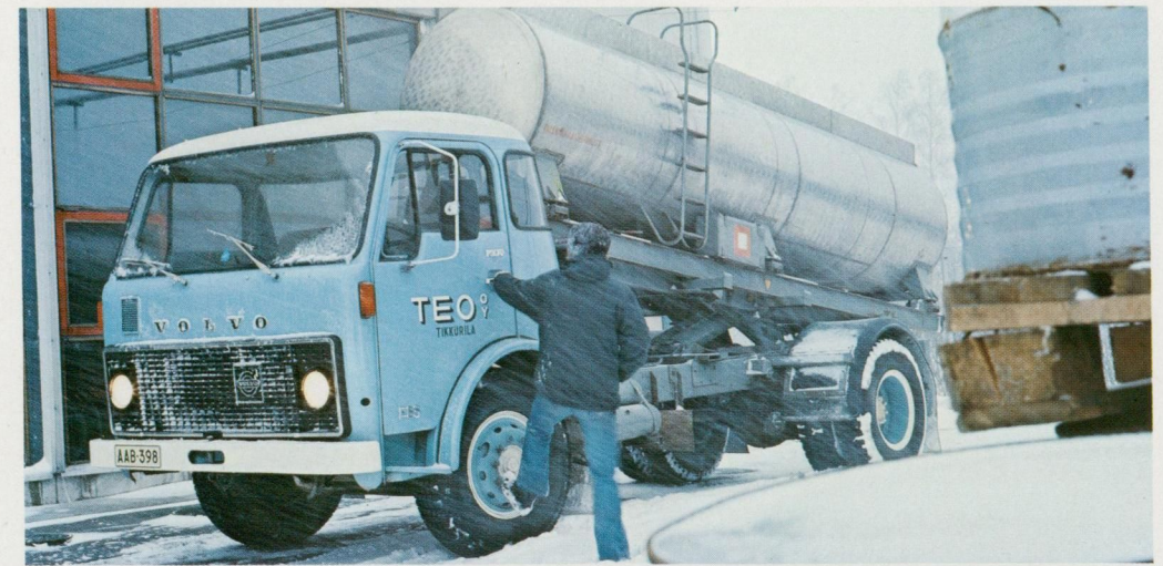
F 85 S-42 med udskiftelig opbygning. Her med tank til transport af renselvædske eller alkohol.
