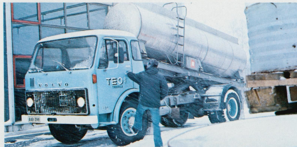
F 85-42 med udskiftelig opbygning. Her med tank til transport af renselvædske eller alkohol.
