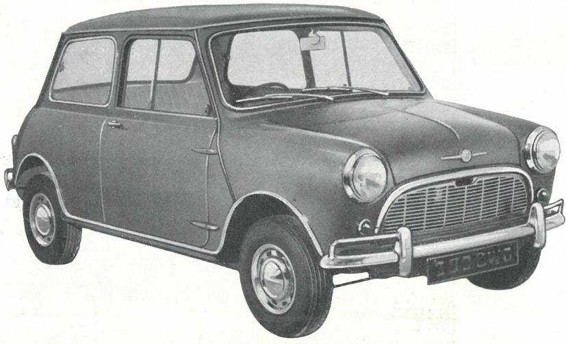
**MORRIS MASCOT.** Alec Issigonis's geniale bilkonstruktion er blevet en succes verden over. En moderne bil uden overflødig pynt — med små ydre mål, men masser af plads indeni. Den tværliggende motor er placeret foran — benzintanken bagi. Hjulenes placering yderst i vognens hjørner i forbindelse med forhjulstræk og Hydrolastic affjedring giver forrygende køreegenskaber. Leveres også i 2 cooper versioner.
