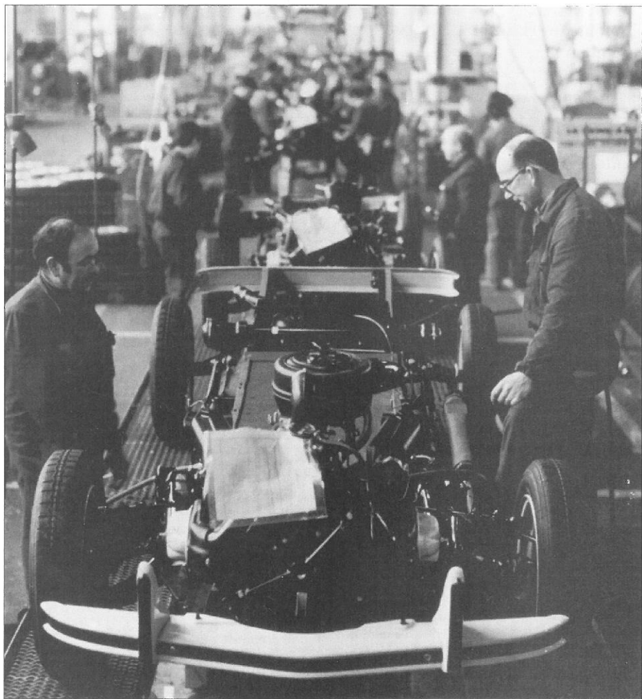
En komplet monteret chassissramme på samlelinjen.
